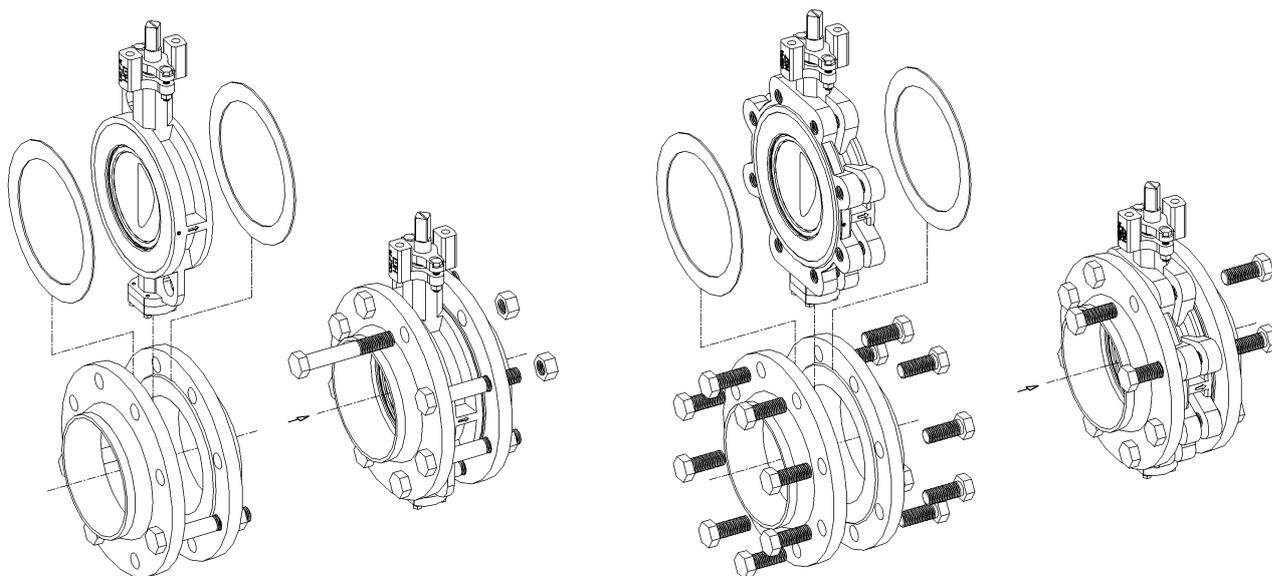
**ОПАСНОСТЬ:** при монтаже отсечной задвижки с корпусом для прифланцовывания в конце трубопровода необходимо дополнительно защитить свободное присоединение фланцевой заглушкой или (только для кратковременного применения) надежно заблокировать арматуру в положении «НЗ». Необходимо обратить внимание на следующие указания по безопасности:
